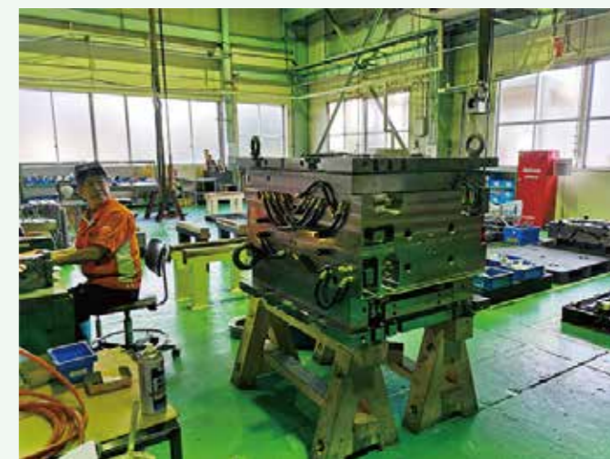
自動車ヘッドライト用樹脂部品の金型でこのサイズ!! この中に IoT センサー(圧力・流量)が仕込まれています
